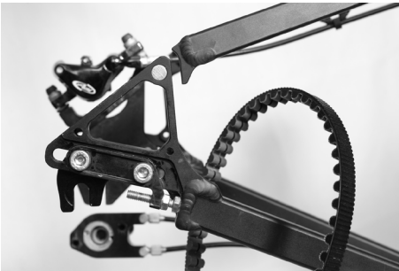
Abbildung 1: Öffnung des Rahmenhecks zur Montage des Riemen
