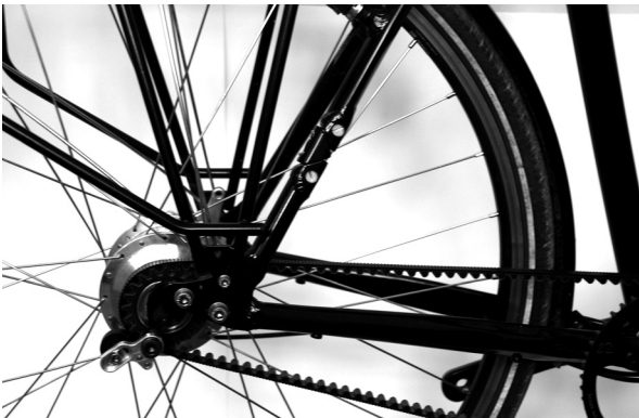
Abbildung 3: Beispiel zur Rahmenkonstruktion: Teilung der Sitzstrebe
