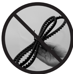
mit Kabelbinder verschnüren
