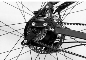
Abbildung 3: Seitenansicht des montierten Snubbers
