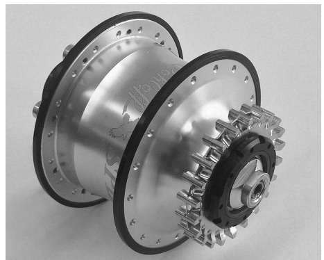
Abbildung 2: Montiertes Rear Sprocket auf einer Rohloff SPEEDHUB 500/1
