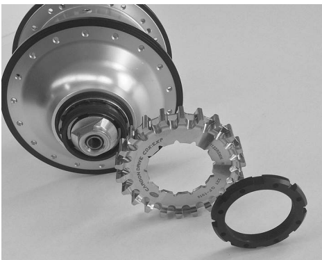
Abbildung 1: Rohloff SPEEDHUB 500/14 mit Splined Carrier und Lock-Ring
