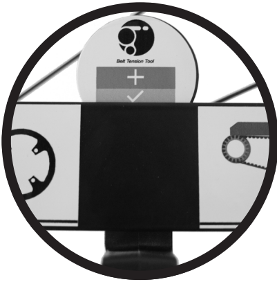
Figure 3: Tension de la courroie optimale
