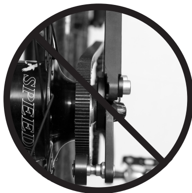
Figure 4: Mauvaise ligne de courroie
