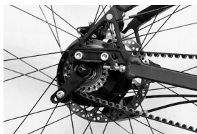
Figure 3: Vue latérale du Snubber monté
