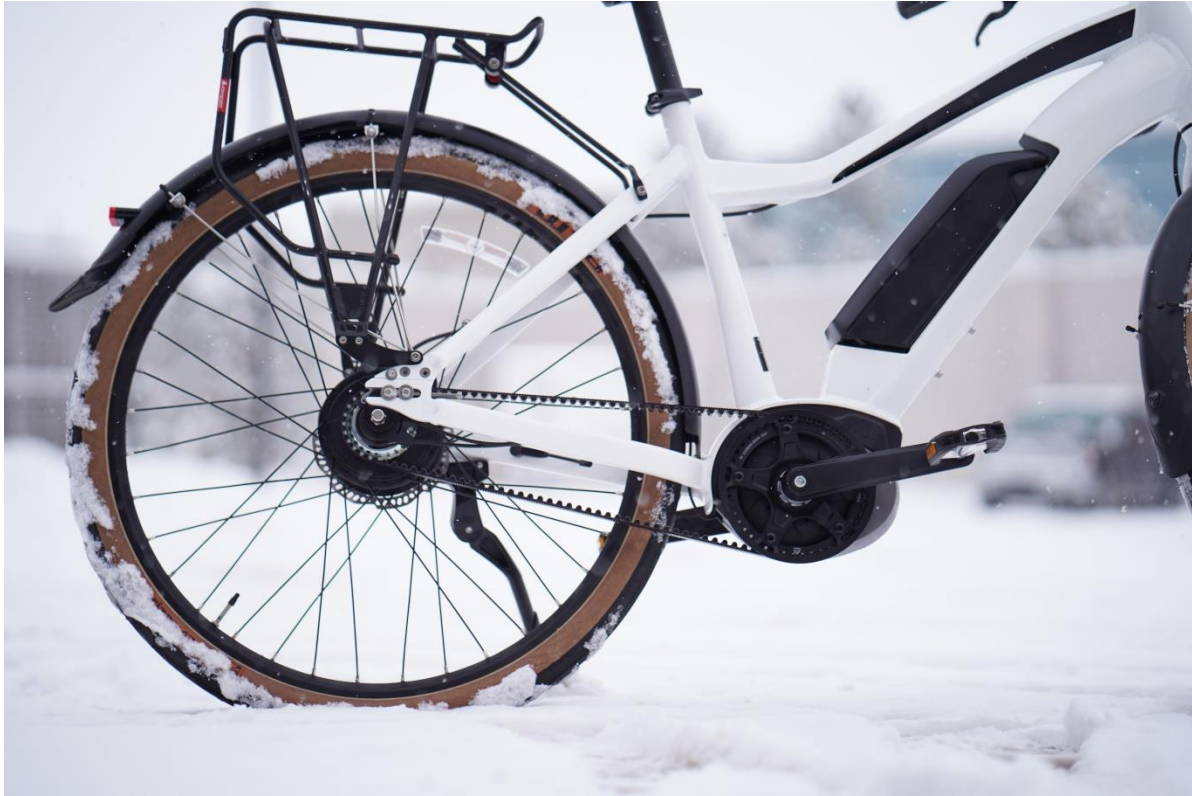
照片 1: 电动自行车上使用 CDC 和 CenterTrack™
