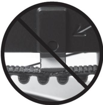
Abbildung 1: Falsche Riemenspannung
