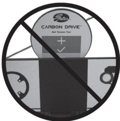
**Abbildung 2: Zu hohe Riemen­spannung**
