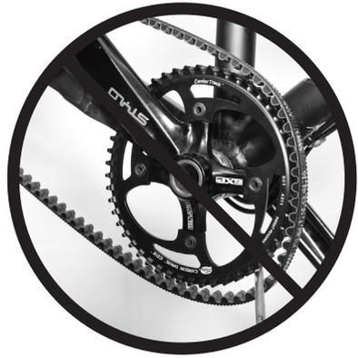
**Montage des Riemen unter Spannung, mit einem Hebel und/oder durch Kurbelumdrehung.**
