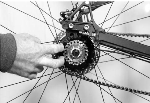
3. Legen Sie den Riemen auf die Zahnriemenscheibe des Hinterrads und montieren Sie das Hinterrad in den Ausfallenden. Folgen Sie hierbei der im Handbuch Ihrer Shimano® Alfine™ oder Nexus™ Nabe beschriebenen Vorgehensweise.
