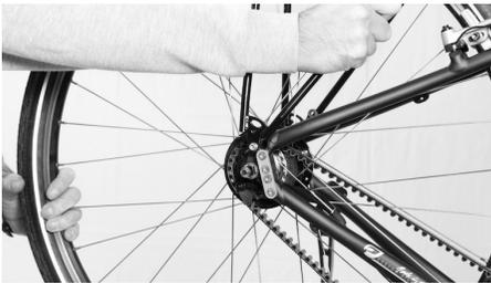
6. Drehen Sie die Kurbel 10 - 15 mal bei freilaufendem Hinterrad. Der Riemen ist richtig eingestellt wenn er gerade läuft und keine Geräusche macht.
