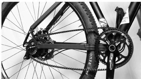
4. Verringern Sie den Abstand zwischen Tretlagerachse und Hinterachse so weit, dass sich der Riemen ohne Spannung auf die vordere Riemenscheibe auflegen lässt. Die technische Ausstattung, um den Abstand zwischen Tretlager und Hinterachse zu verringern, kann
