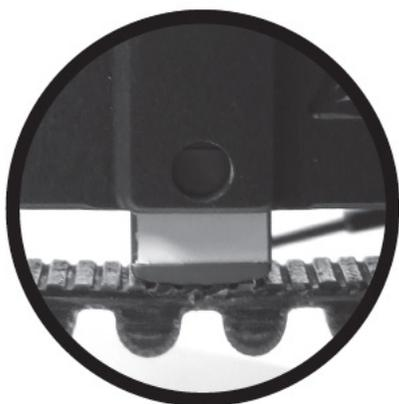
**Abbildung 3: Optimale Riemen­spannung**
