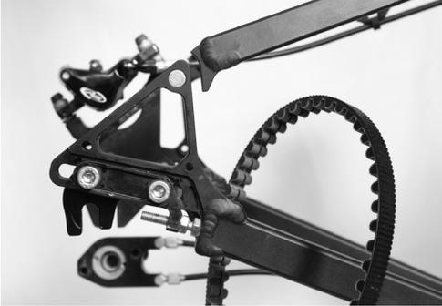
1. Öffnen Sie den Verschluss des hinteren Rahmendreiecks (Rahmenschluss). Beachten Sie dazu die Hinweise Ihres Rahmenherstellers, da die Verschlüsse je nach Hersteller variieren können. In den nachfolgenden Abbildungen wird der Rahmen am Ausfallende geöffnet. Legen Sie den Riemen durch die Öffnung des Rahmens ein.
