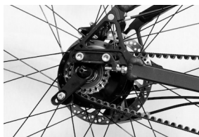
Afbeelding 3: Zijaanzicht van de gemonteerde snubber
