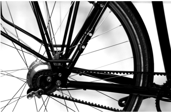
Afbeelding 3: voorbeeld van een frameconstructie: opening in de staande achtervork
