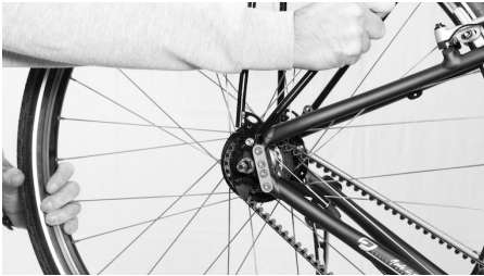
Afbeelding 3: correcte uitlijning van de riem
