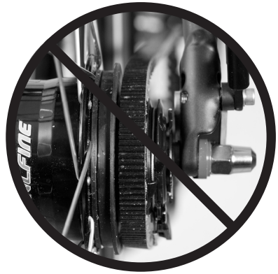
Afbeelding 4: onjuiste uitlijning van de riem
