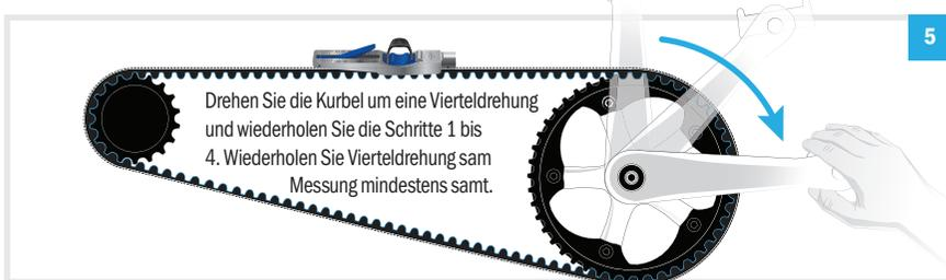
Drehen Sie die Kurbel um eine Vierteldrehung und wiederholen Sie die Schritte 1 bis 4. Wiederholen Sie Vierteldrehung sam Messung mindestens samt.
