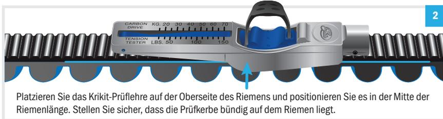
Platzieren Sie das Krikkit-Prüflehre auf der Oberseite des Riemens und positionieren Sie es in der Mitte der Riemenlänge. Stellen Sie sicher, dass die Prüfkerbe bündig auf dem Riemen liegt.
