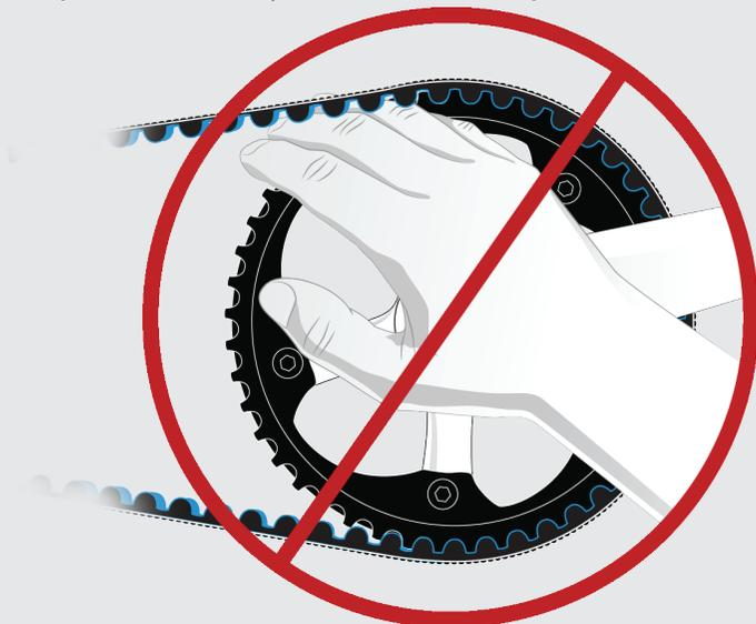
Правильное натяжение ремня очень важно для оптимальной работы системы Gates Carbon Drive. Недостаточное натяжение ремня может привести к перескакиванию зубьев или к «проскальзыванию», когда зубья ремня скользят по зубьям задней звездочки. Слишком сильное натяжение может привести к повреждению подшипников задней втулки, подтормаживанию системы и к повышенному износу системы привода.
