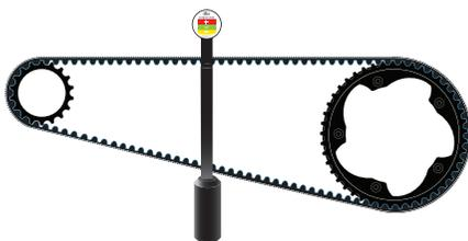
2 Положите линейку на обе звездочки. Проверьте натяжение:
